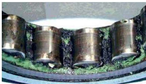
Zhoršení kvality maziva způsobené výbojovými proudy
